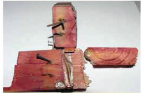
写真2 Bora-Care 処理構造材断面
